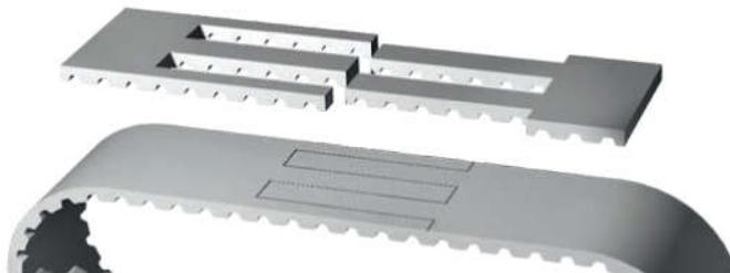
Nekonečné ozubené řemeny „V“ se vyrábí svařováním konců PU metráží. Tako lze vyrobit řemen jakékoliv délky. Minimální délka je limitována pouze rozměry formy svařovacího zařízení. Řemen má ve spoje pouze 50% pevnost, je proto vhodný především pro transportní účely. Stejně jako na běžné PU řemeny lze na řemeny „V“ nanášet povrchové vrstvy nebo je osadit unášeči.
