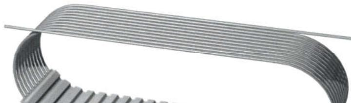
Nekonečné polyuretanové ozubené řemeny FLEX se vyrábí bez spoje s nepřerušeným tažným vláknem v jakémkoliv délce vymezeného rozsahu. Používají se při potřebách nestandardních délek řemenů, při zachování vysokého přenosu výkonu. Stejně jako na všechny PU řemeny, lze na řemeny FLEX nanášet povrchové vrstvy nebo je osadit unašeči.
