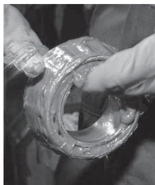
Obr. 14. Plasticke mazivo lze snadno plnit ručně
