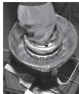
Obr. 15. Mechanický dávkovač maziva
